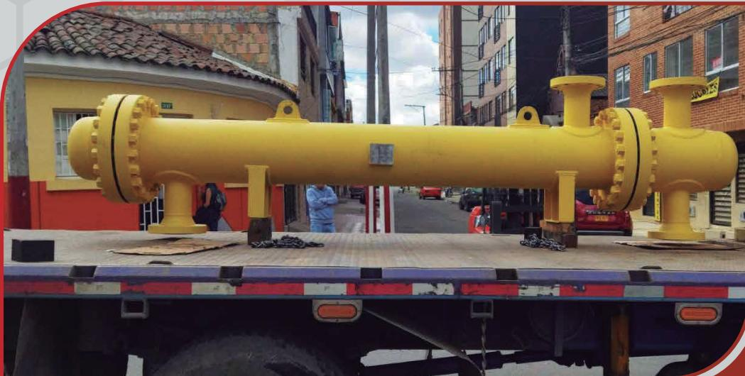
Intercambiador de calor tipo BEM de 16" Rating 600
